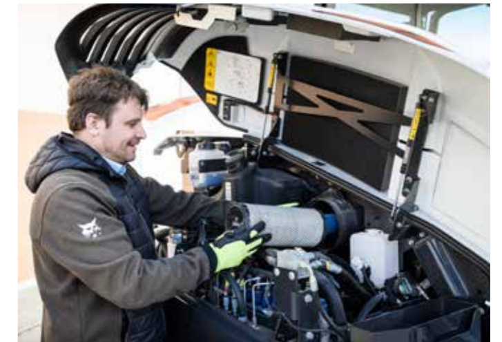
Remplacement des filtres
