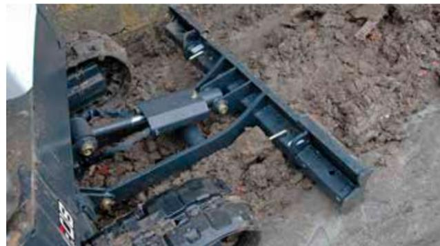
Machines équipées de série d'un châssis inférieur à voie variable et d'une lame réglable. Par conséquent, nul besoin de déposer et d'installer des rallonges de lame.
