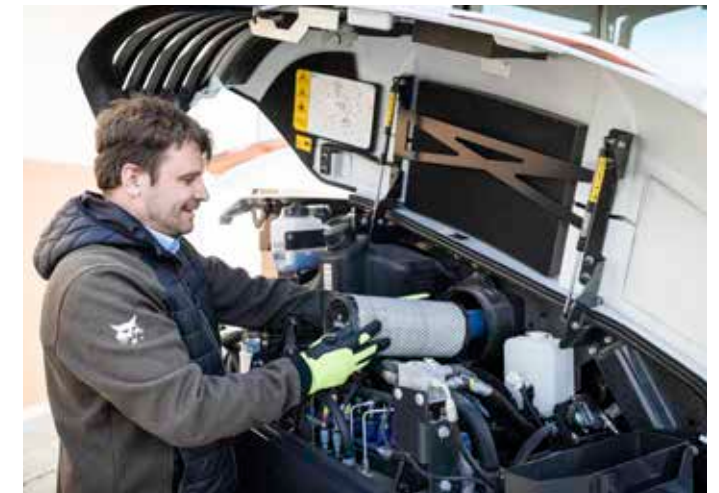
Remplacement des filtres
